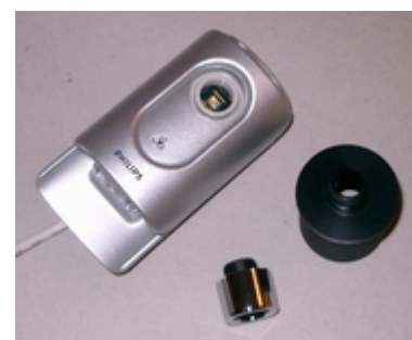
Webcam con objetivo desenroscable y adaptador para portaocular
