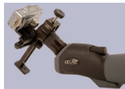
Cámara compacta acoplada a telescopio mediante digiscope según método afocal
