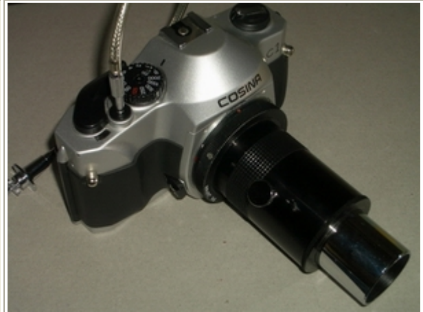
Cámara equipada para fotografía por proyección de ocular
